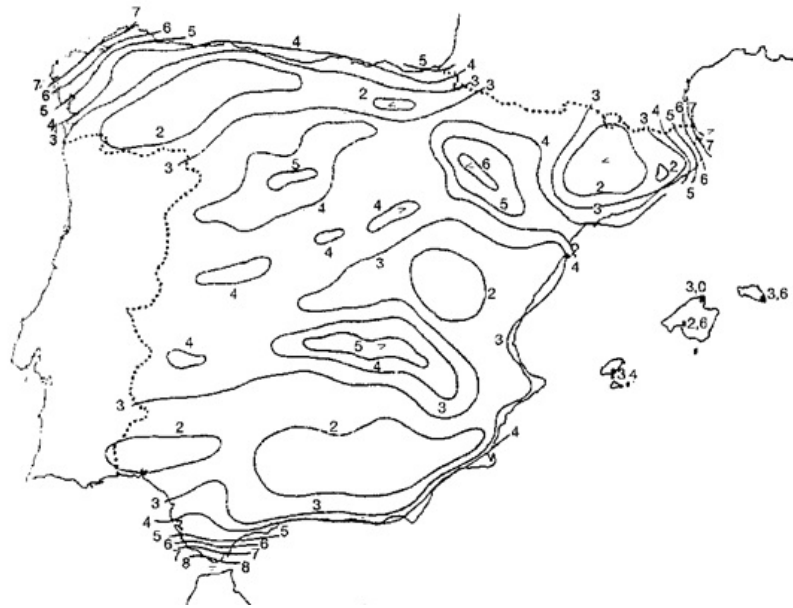
Figura 4: Mapa con velocidades medias del viento en la península Ibérica y Baleares, medidas a 1 m de altura (m/s). Fuente: Miguel Villarubia.
