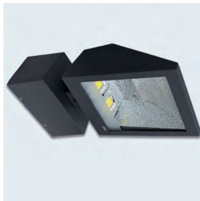
mod. PSO . Proyector Orientable Potencia: 10W a 40W Tensión: 12/24VDC ó 230VAC / IP65 - IK10 Tº de color: 3.800K - 4.500K Fabricación propia
