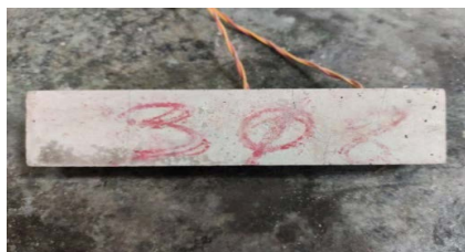
Figura 3. Probeta 3 correspondiente a la barra de diámetro 8 mm.
