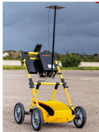
Equipo CENmapper, de GeoCENmap, para medición del campo eléctrico a nivel de la superficie.
